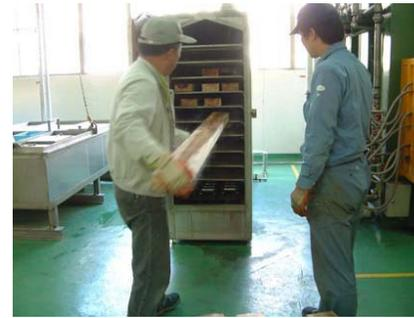
高圧真空蒸煮釜(最高到達点120°C)
