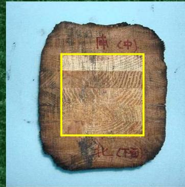
燃焼実験後の断面
