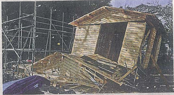
①ワイヤで震度5強から6弱の力で引っ張られ、倒壊した旧耐震基準の家屋模型(28日、宇治市・京都大防災研究所)②角材を連結した「壁柱」(大阪府木材連合会提供)
