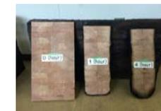
火災後、元の断面から燃え代を除いた「燃え残り断面」で崩壊を防げばよい。
