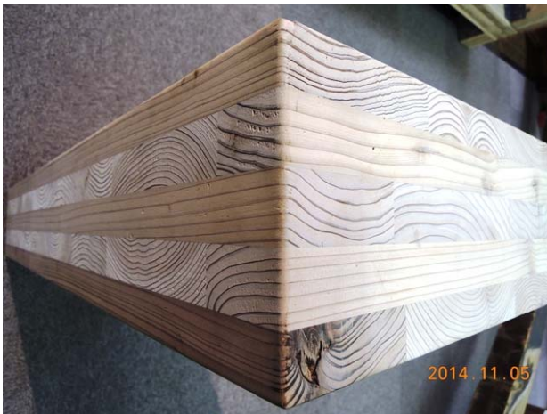
CLT: ひき板を直交に積層
