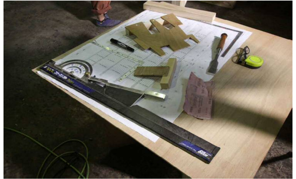
様々な角度のホゾ穴加工のための型板
