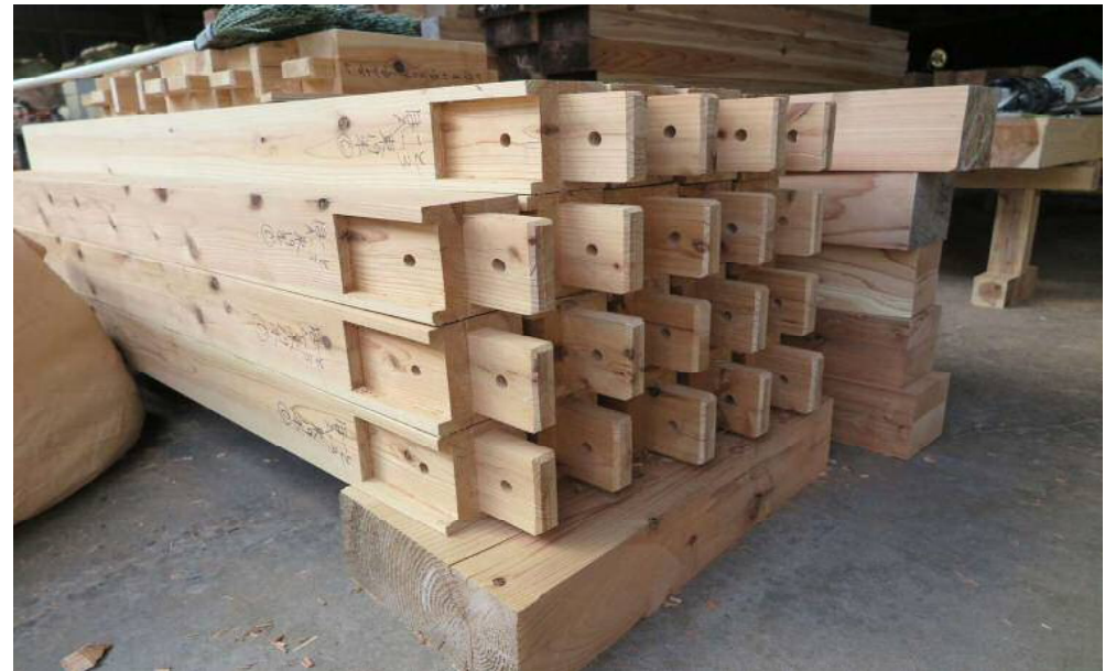
方杖連続トラス 嵌合部の加工
