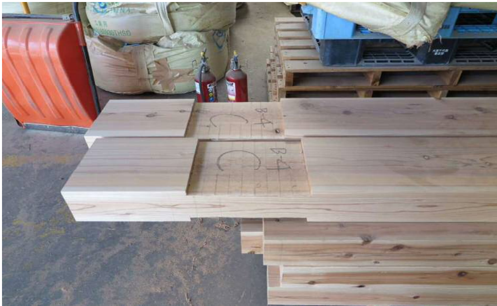
舟底型の張弦トラス 嵌合部の加工
