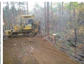
左からグラップル、スキッド、ブルドーザによる木寄せ、集材過程
