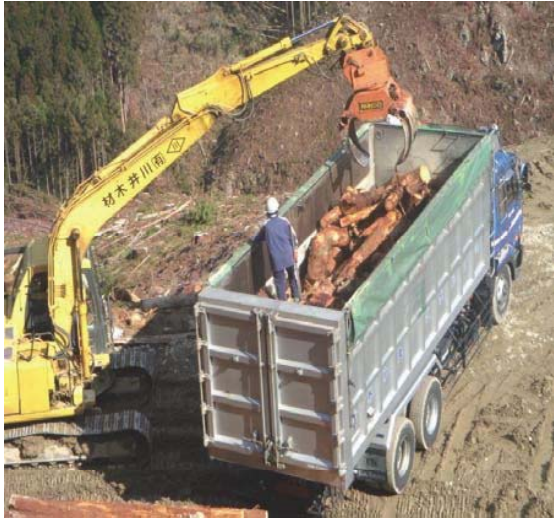
端材のグラップルによる積み込み作業
