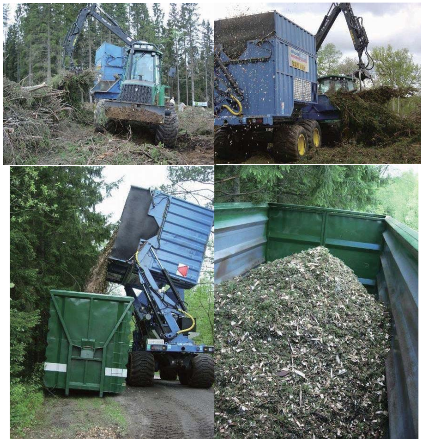
写真2. 12. 29 スウェーデンにおける末木枝条の燃料化の現場 (上段：移動式チップパー、下段：運搬用コンテナへの積み替え)
