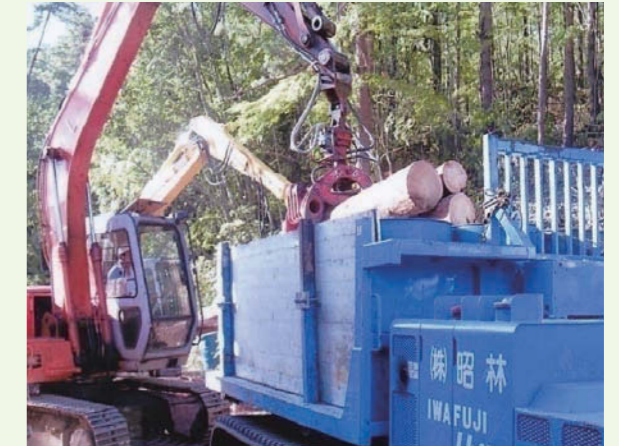
フォワーダ積込作業
