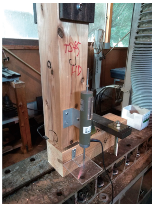
写真3 ホールダウン金物による接合部試験 (スギの例)
