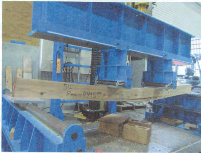
写真1 実大曲げ試験の様子（スギ心持ち平角）
