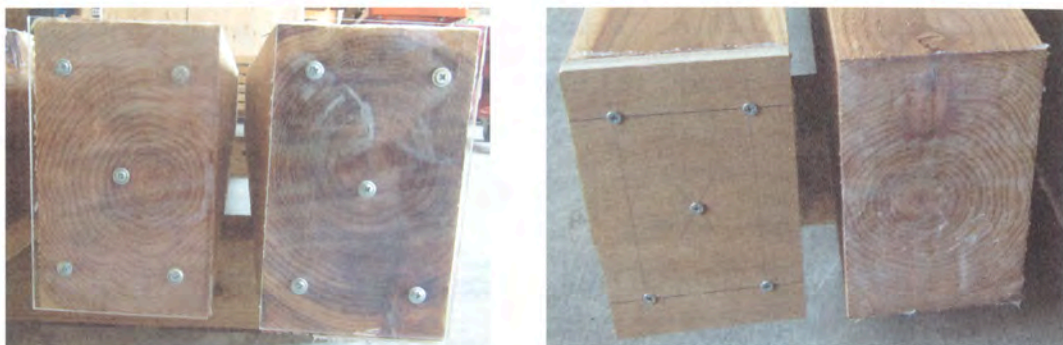
写真4 木口シールの例（左写真：木口シール+アクリル板、右写真の左：木口シール+合板、右写真の右：木口シールのみ）
