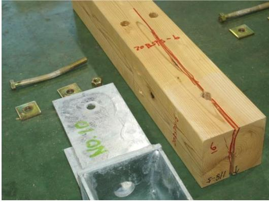
写真 3.8.14-70 6体目 割裂破壊
