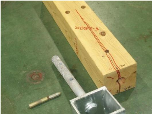
写真 3.8.12-5 3 体目 割裂破壊
