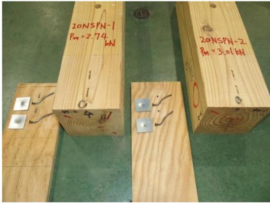
写真 3.8.1-4 1、2 体目の破壊性状
