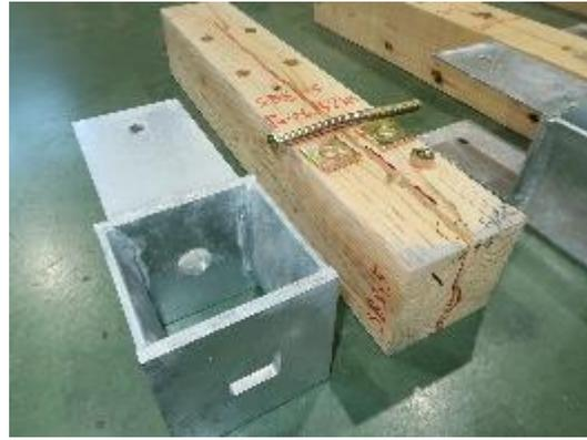
写真 3.7.14-69 5 体目 割裂破壊
