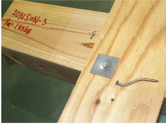
写真 3.8.3-5 3 体目の破壊性状
