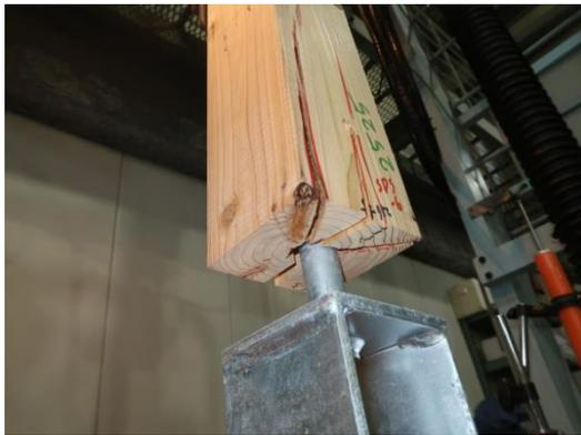
写真 3.7.12-9 6体目 割裂破壊
