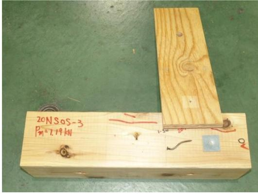
写真 3.8.4-5 3 体目の破壊性状
