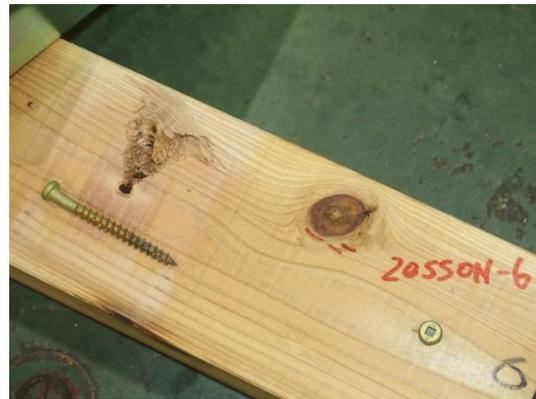
写真 3.8.7-8 6体目の破壊性状
