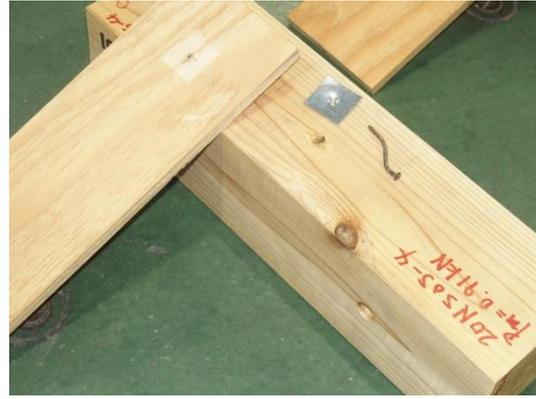
写真 3.8.4-6 4 体目の破壊性状
