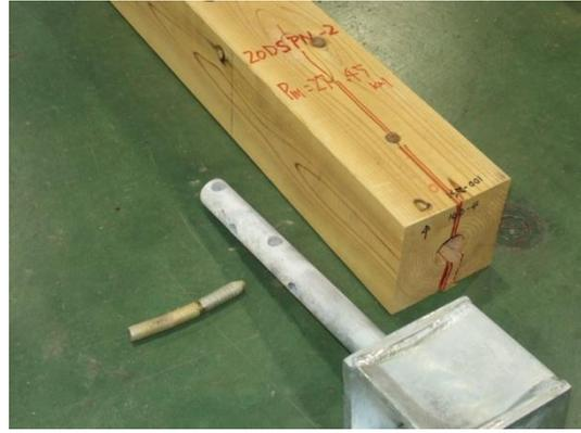
写真 3.8.11-4 2 体目の破壊性状
