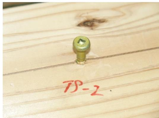
写真 3.7.10-4 2 体目の破壊性状
