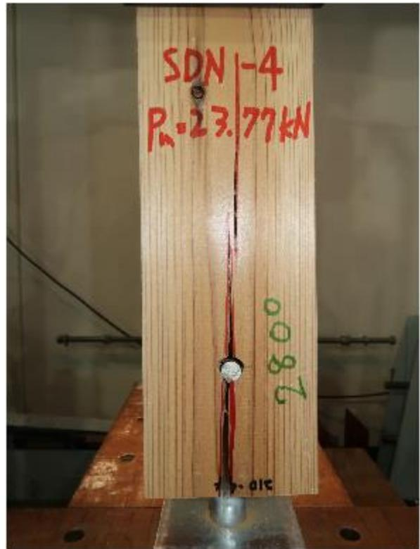
写真 3.7.11-2 4体目 割裂破壊
