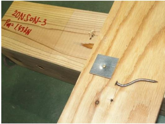
写真 3.8.3-7 5、6 体目の破壊性状
