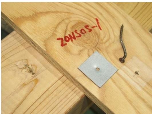
写真 3.8.4-3 くぎ、座金の変形、合板のめり込み
