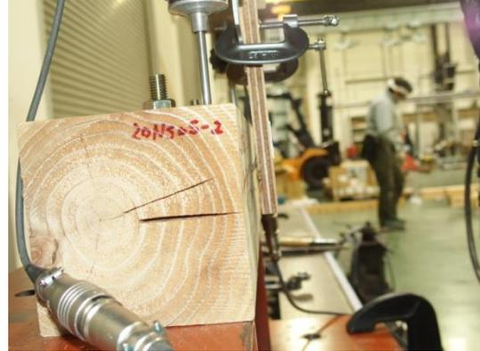
写真 3.6.4-2 KD20-25 試験体のスリット
