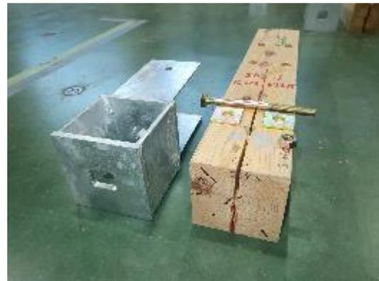
写真 3.7.14-65 1 体目 割裂破壊
