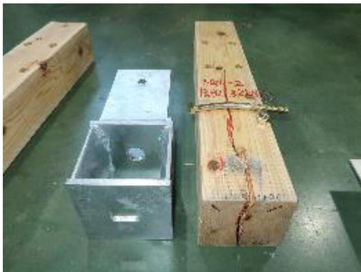
写真 3.7.13-3 2 体目 割裂破壊
