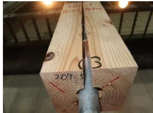
写真 3.7.12-2 1 体目 割裂破壊
