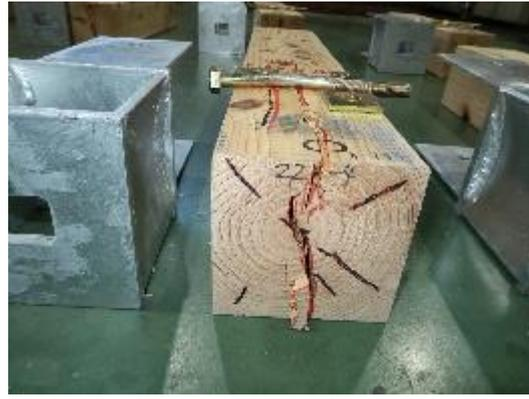
写真 3.7.13-6 5 体目 割裂破壊
