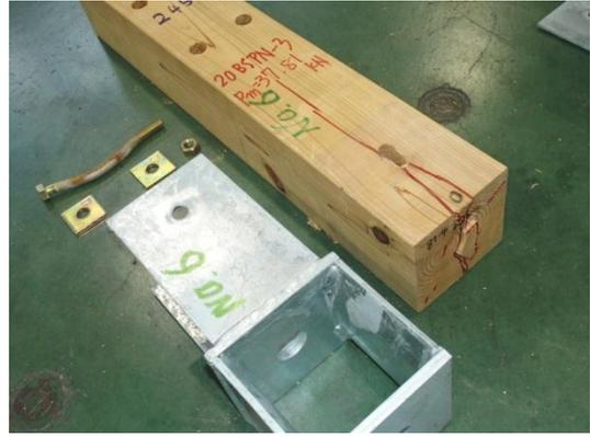
写真 3.8.13-4 3 体目 押し抜きせん断破壊
