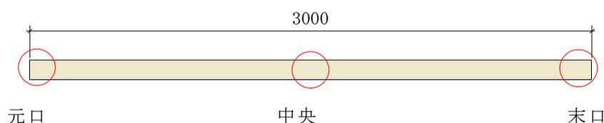
図 2.2-1 マイクロ波による含水率測定(末口、中央、元口)
