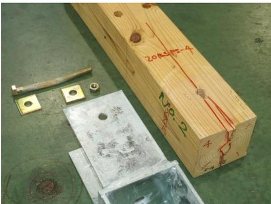
写真 3.8.14-68 4体目 割裂破壊
