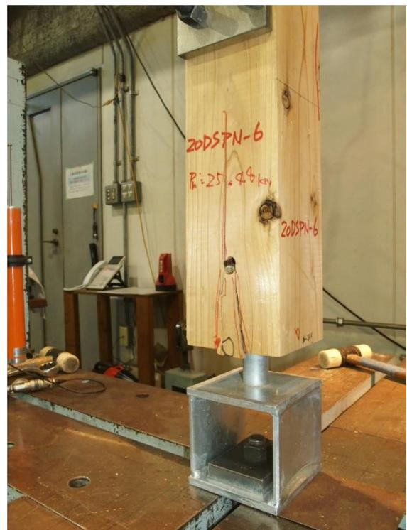
写真 3.8.11-2 6 体目 押し抜きせん断破壊
