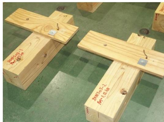
写真 3.8.4-4 1~2 体目の破壊性状
