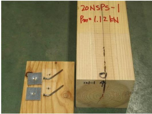
写真 3.8.2-4 1体目の破壊性状
