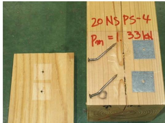
写真 3.8.2-7 4体目の破壊性状
