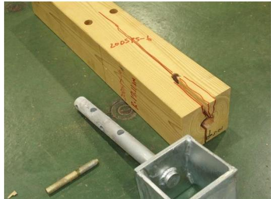
写真 3.8.12-8 6 体目 押し抜きせん断破壊
