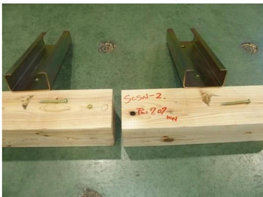
写真 3.7.7-3 1~2 体目の破壊性状
