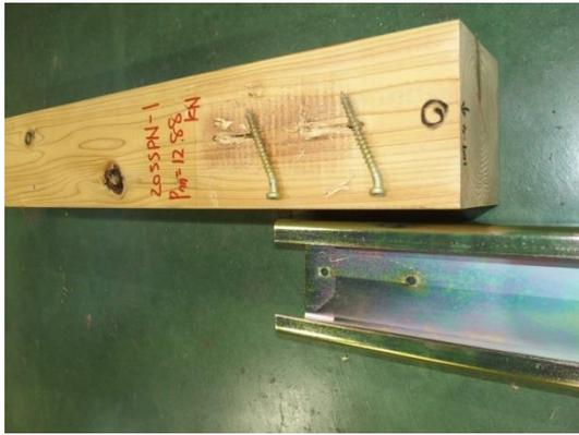
写真 3.8.5-4 1 体目の破壊性状
