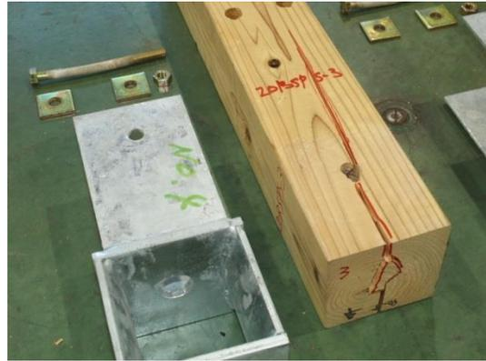
写真 3.8.14-4 3体目 割裂破壊
