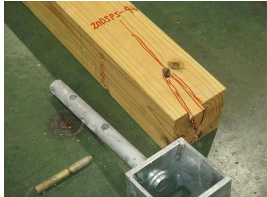
写真 3.8.12-6 4 体目 押し抜きせん断破壊
