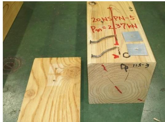
写真 3.8.1-7 5 体目の破壊性状
