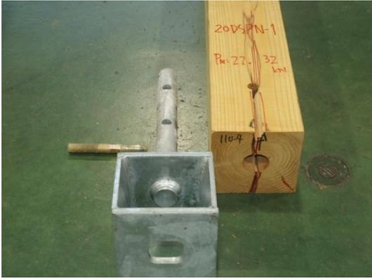
写真 3.8.11-3 1 体目の破壊性状
