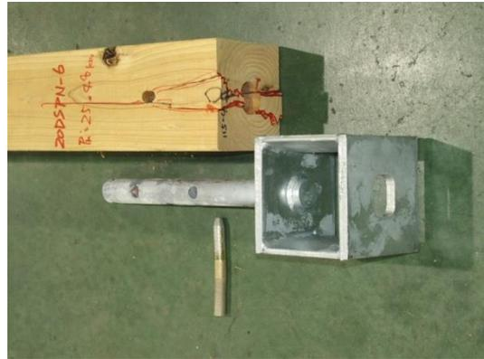
写真 3.8.11-6 6 体目の破壊性状
