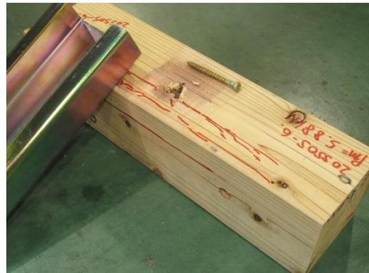
写真 3.8.8-7 6 体目の破壊性状
