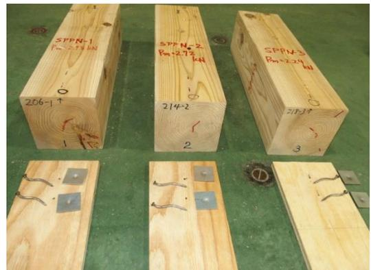
写真 3.7.1-2 1~3 体目の破壊性状
