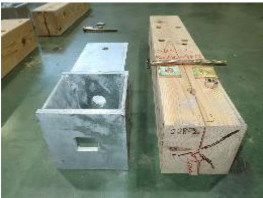
写真 3.7.14-66 2 体目 割裂破壊
