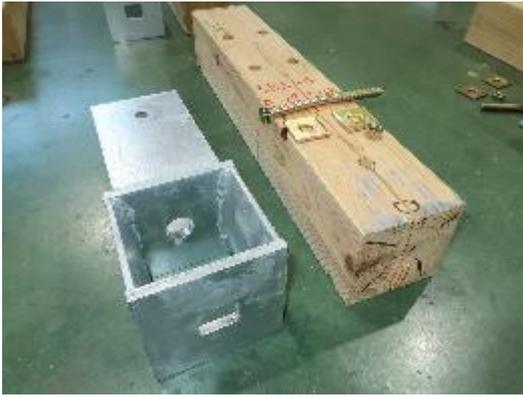
写真 3.7.14-68 4 体目 割裂破壊
