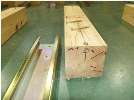
写真 3.8.6-8 5 体目の破壊性状
