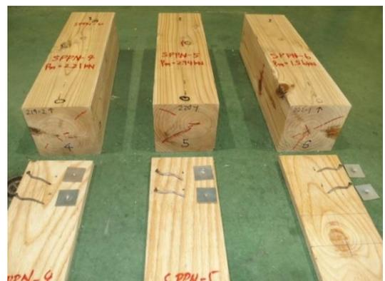
写真 3.7.1-3 4~6 体目の破壊性状
