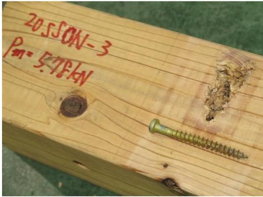
写真 3.8.7-5 3体目の破壊性状
