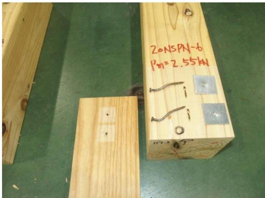
写真 3.8.1-8 6 体目の破壊性状
