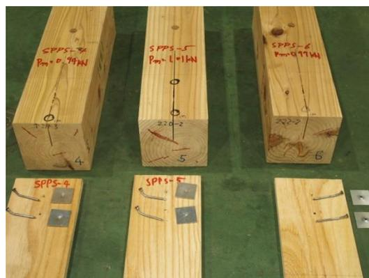
写真 3.7.2-4 4~6 体目の破壊性状
