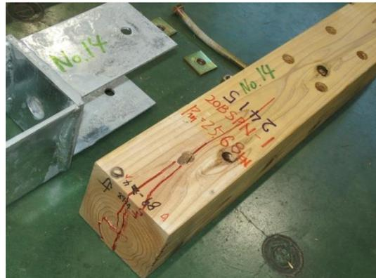
写真 3.8.13-2 1 体目 押し抜きせん断破壊
