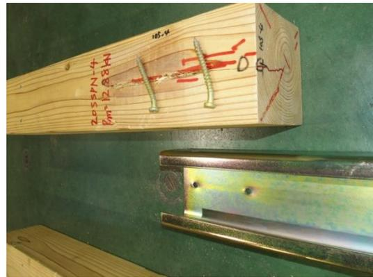
写真 3.8.5-7 4 体目の破壊性状
