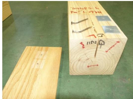
写真 3.8.2-9 6体目の破壊性状
