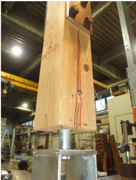
写真 3.8.12-1 3 体目 割裂破壊
