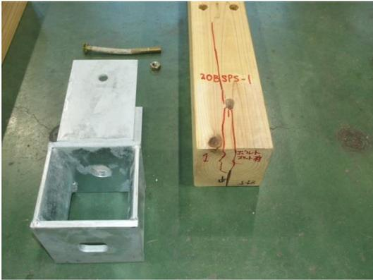
写真 3.8.14-3 2体目 割裂破壊
