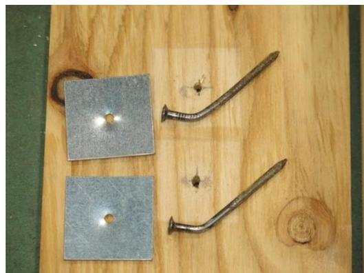
写真 3.8.2-3 くぎ、座金の変形、合板のめり込み
