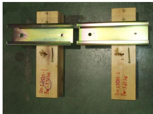
写真 3.8.7-4 1, 2体目の破壊性状
