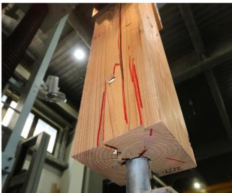
写真 3.7.12-3 1 体目 割裂破壊
