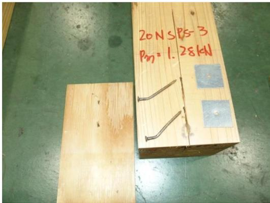
写真 3.8.2-6 3体目の破壊性状
