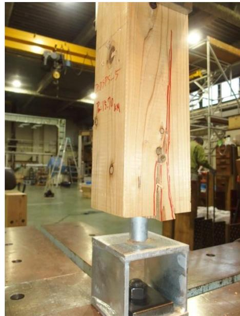
写真 3.8.12-2 5 体目 押し抜きせん断破壊
