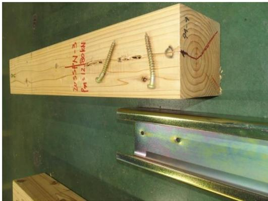
写真 3.8.5-6 3 体目の破壊性状
