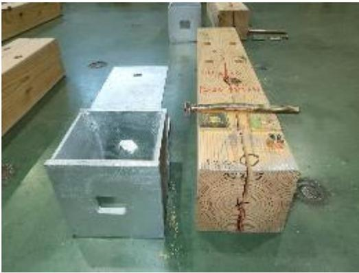
写真 3.7.14-70 6 体目 割裂破壊
