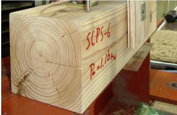
写真 3.6.4-1 KD15 試験体のスリット
