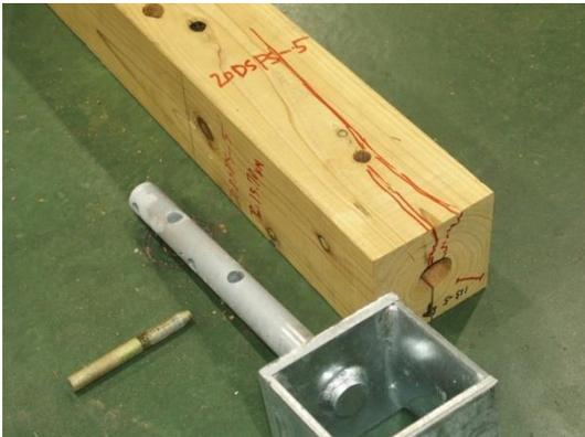
写真 3.8.12-7 5 体目 押し抜きせん断破壊
