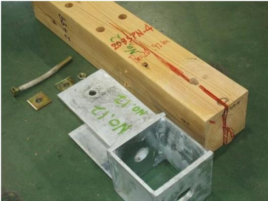
写真 3.8.13-5 4 体目 割裂破壊+押し抜きせん断破壊
