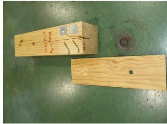
写真 3.8.2-5 2体目の破壊性状
