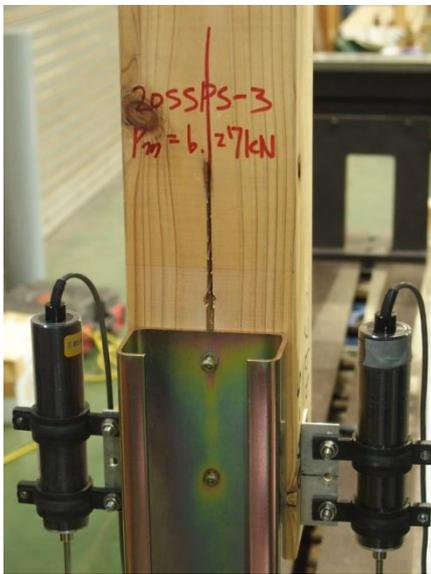
写真 3.8.6-1 試験後の様子(スリットに沿って割れ発生)
