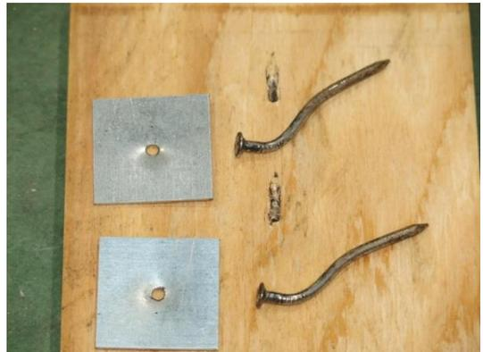
写真 3.8.1-3 くぎ、座金の変形、合板のめり込み
