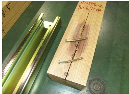
写真 3.8.6-3 2体目の破壊性状
