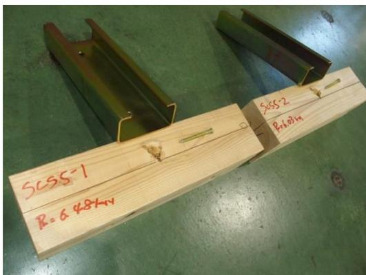
写真 3.7.8-3 1~2 体目の破壊性状
