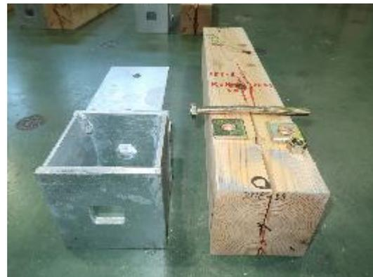
写真 3.7.14-67 3 体目 割裂破壊
