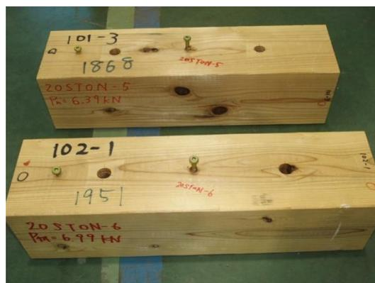
写真 3.8.9-4 5、6 体目の破壊性状
