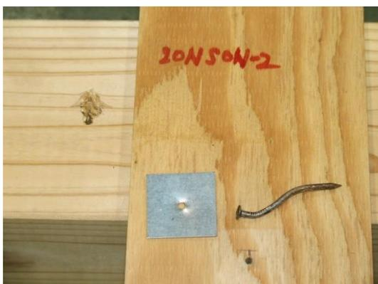
写真 3.8.3-3 くぎ、座金の変形、合板のめり込み
