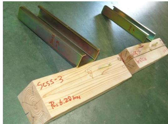
写真 3.7.8-2 3~4 体目の破壊性状
