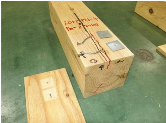
写真 3.8.1-6 4 体目の破壊性状
