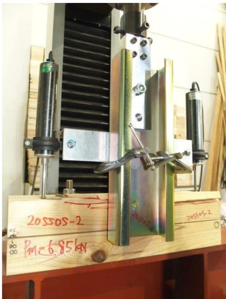
写真 3.8.8-1 試験後の様子(スリットに沿って割れ発生)
