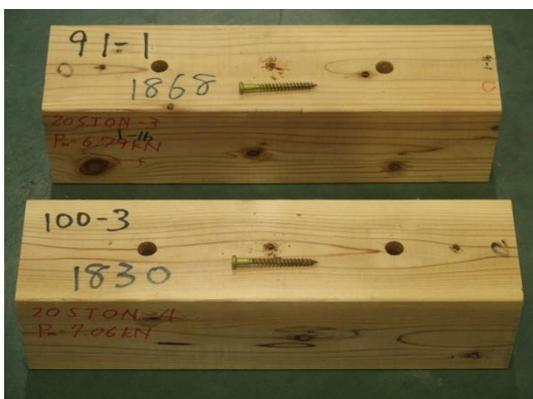
写真 3.8.9-3 3、4 体目の破壊性状
