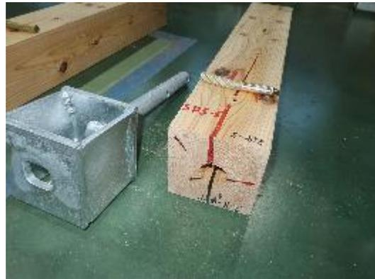
写真 3.7.12-8 解体後 5体目 割裂破壊
