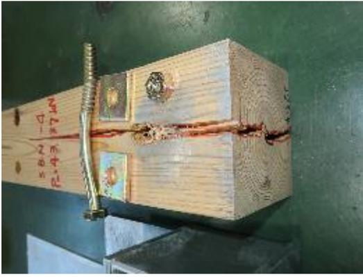
写真 3.7.13-5 4 体目 割裂破壊
