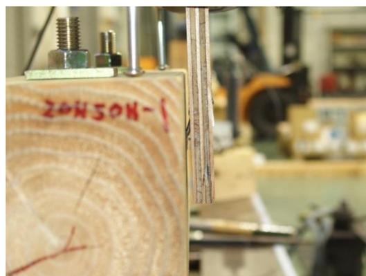
写真 3.8.3-2 試験後 合板の離間
