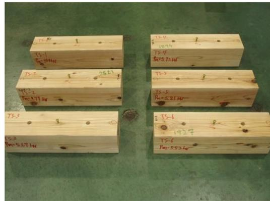
写真 3.7.10-2 1~6 体目の破壊性状
