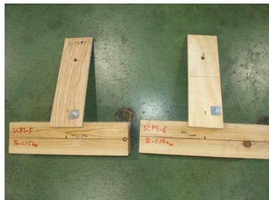
写真 3.7.4-4 5~6 体目の破壊性状
