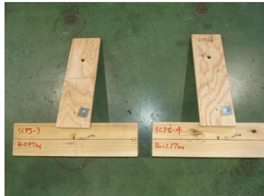
写真 3.7.4-2 3~4 体目の破壊性状
