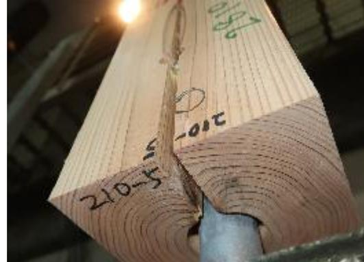
写真 3.7.12-4 2 体目 割裂破壊
