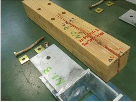
写真 3.8.13-3 2 体目 割裂破壊
