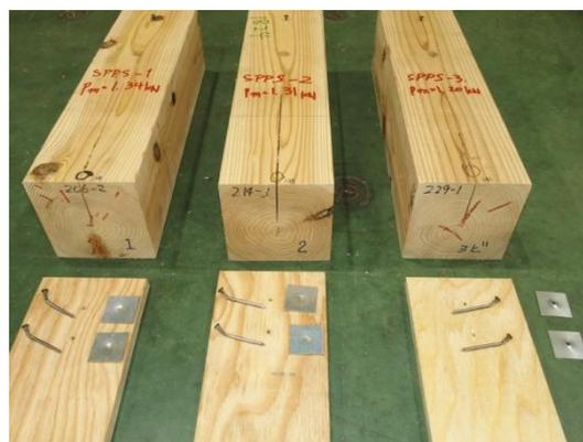
写真 3.7.2-2 1~3 体目の破壊性状
