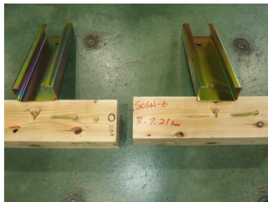
写真 3.7.7-4 5~6 体目の破壊性状
