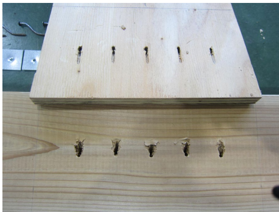
写真 3.5.2-24 1 体目 くぎによる木材の めり込み
