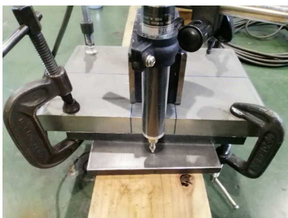
写真 3.6.2-3 測定中は平滑な鋼板の上でイニシャル値をゼロに戻すを繰り返す
