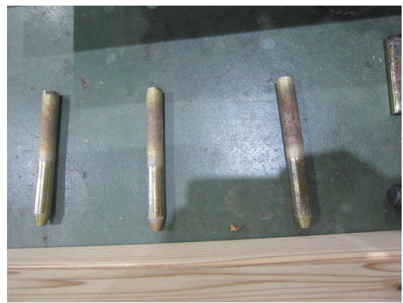
写真 3.5.5-46 HPDSP-1 ドリフトピンの腐食
