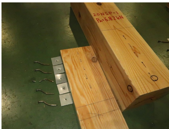
写真 3.5.1-22 1 体目破壊性状
