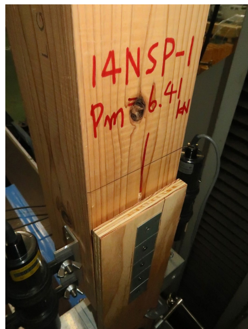
写真 3.5.1-12 14 NSP-1 くぎ列に沿った木材の割れ
