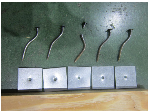
写真 3.5.1-20 20NSP-1 くぎの変形・破断
