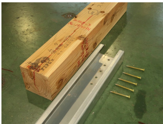
写真 3.5.3-7 3体目破壊性状
