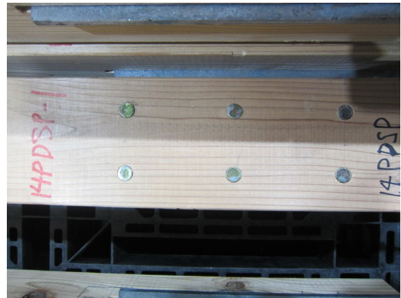
写真 3.6.4-4 KDG14 試験体の調湿後の様子
