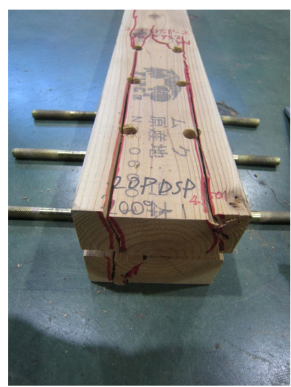
写真 3.5.5-32 20PDSP-2 木材の割れ
