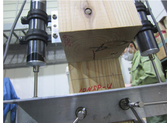
写真 3.5.1-3 10NSP-4 くぎ列に沿った木材の割れ
