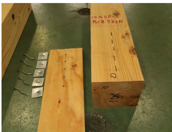
写真 3.5.1-10 6 体目破壊性状
