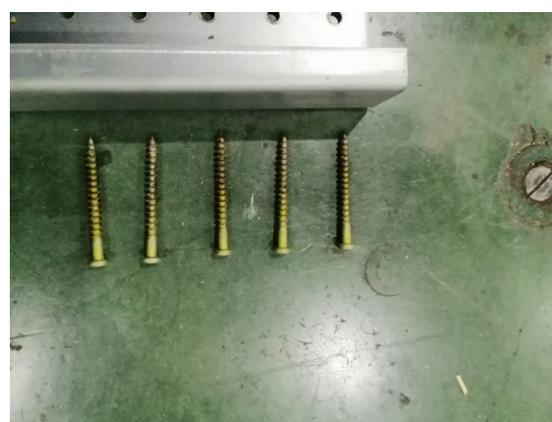
写真 3.5.3-24 ビスの変形なし
