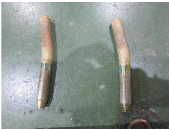
写真 3.5.4-35 ドリフトピンの曲げ変形と腐食
