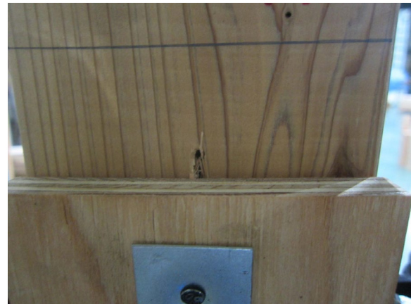
写真 3.5.1-5 10NSP-6 くぎによる木材のめり込み
