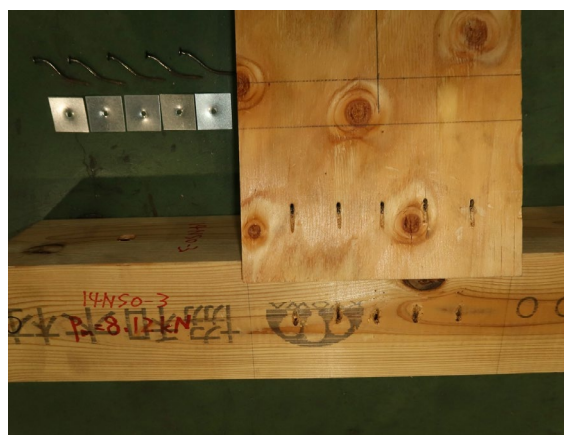
写真 3.5.2-15 3 体目破壊性状
