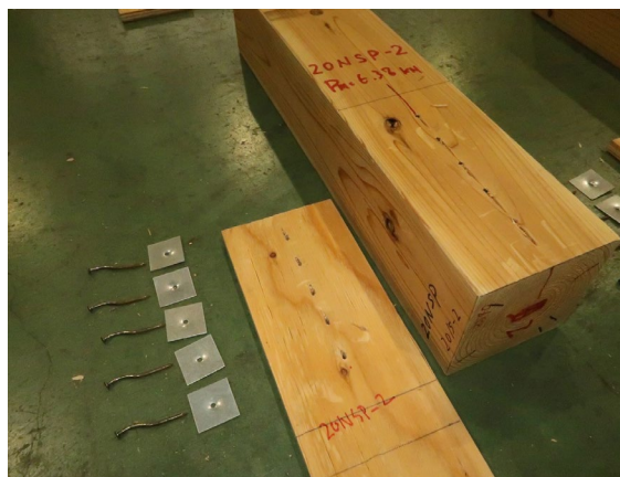
写真 3.5.1-23 2 体目破壊性状
