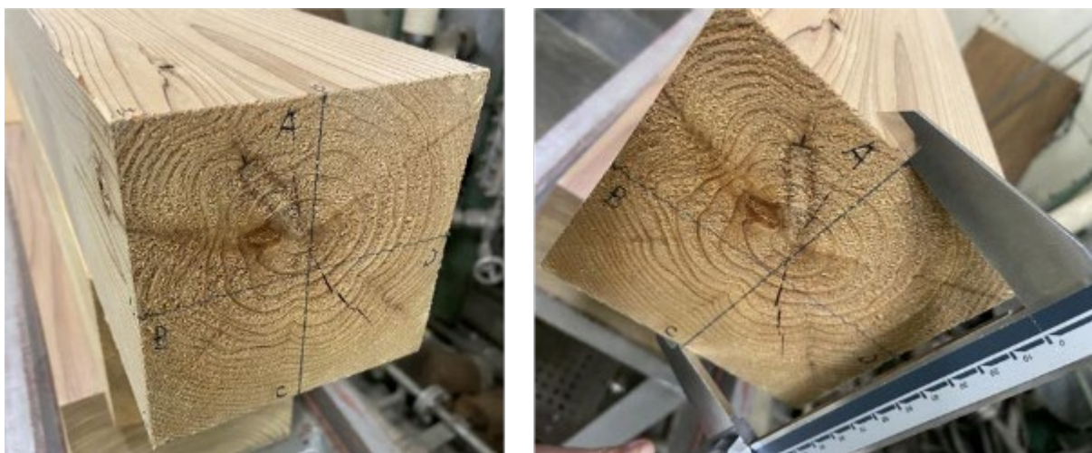
写真 2.4.3.5-1 木口面と切断面の寸法測定方法
