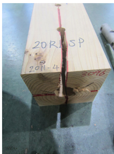
写真 3.5.4-26 20RDSP-2 木材の割れ
