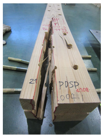
写真 3.5.5-38 20PDSP-4 木材の割れ
