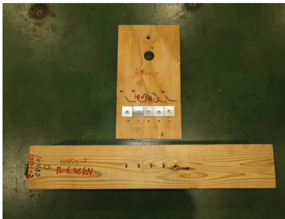
写真 3.5.2-10 5 体目破壊性状
