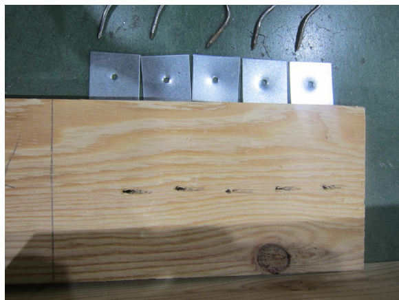
写真 3.5.1-19 20NSP-1 解体後 くぎによる木材のめり込み
