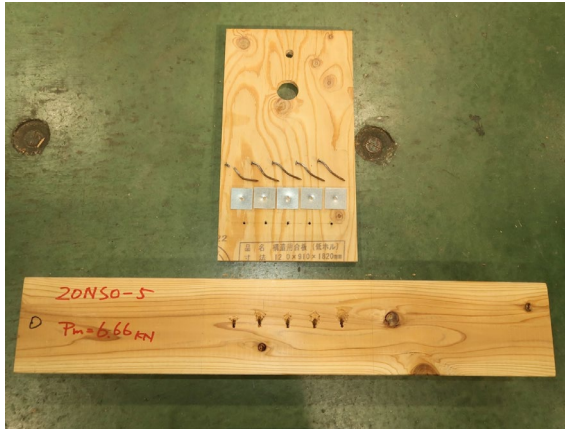
写真 3.5.2-22 5 体目破壊性状
