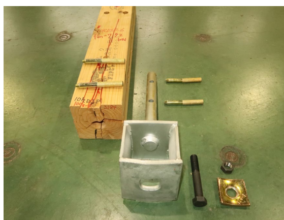
写真 3.5.4-14 10RDSP-6 木材の割れ
