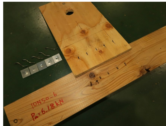
写真 3.5.2-11 6 体目破壊性状
