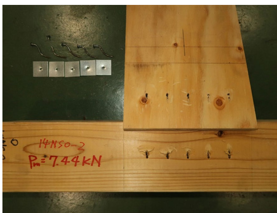
写真 3.5.2-14 2 体目破壊性状
