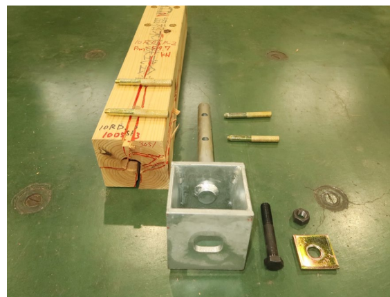
写真 3.5.4-6 10RDSP-2 木材の割れ
