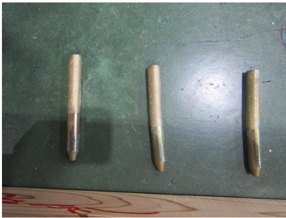
写真 3.5.5-5 10PDSP-1 ドリフトピンの変形
