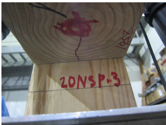
写真 3.5.1-18 20NSP-3 木口割れ
