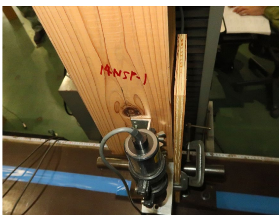
写真 3.5.1-13 14 NSP-1 面材の浮き
