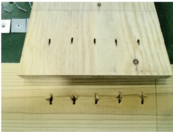
写真 3.5.2-4 10NSO-1 くぎによる木材の支圧
