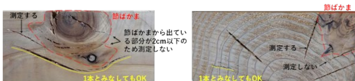
図 2.4.3.4-1 測定する割れの対象例
