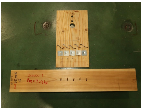
写真 3.5.2-18 1 体目破壊性状
