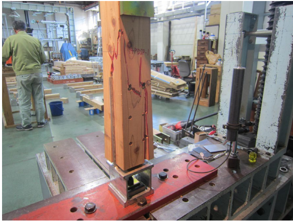
写真 3.5.5-21 14PDSP-1 木材の割れ
