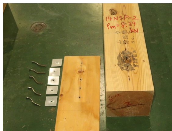
写真 3.5.1-16 2 体目破壊性状
