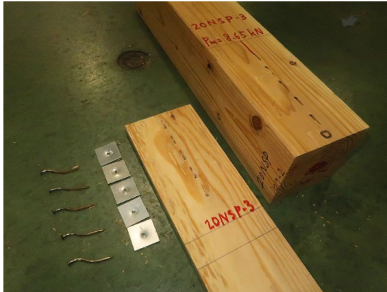
写真 3.5.1-24 3 体目破壊性状
