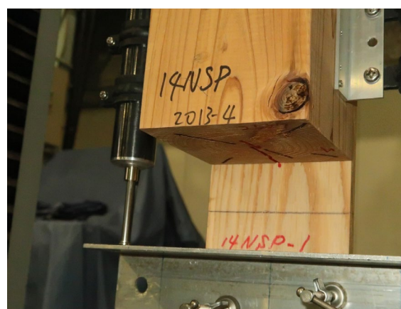
写真 3.5.1-14 14 NSP-1 木口割れ
