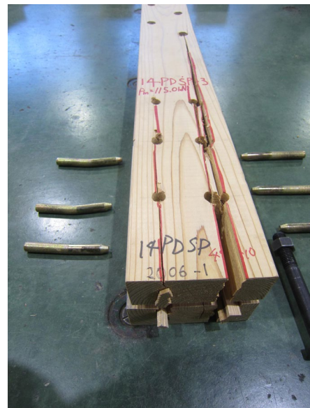
写真 3.5.5-28 14PDSP-3 木材の割れ
