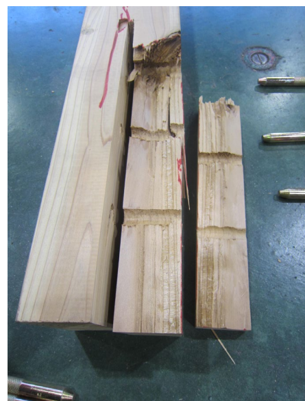
写真 3.5.5-8 10PDSP-2 木材の割れ
