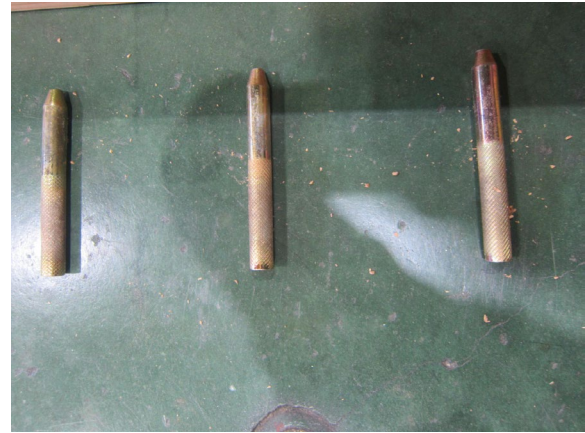
写真 3.5.5-22 14PDSP-1 ドリフトピン
