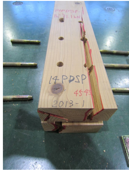
写真 3.5.5-20 14PDSP-1 木材の割れ
