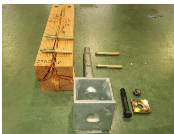
写真 3.5.4-32 20RDSP-5 木材の割れ
