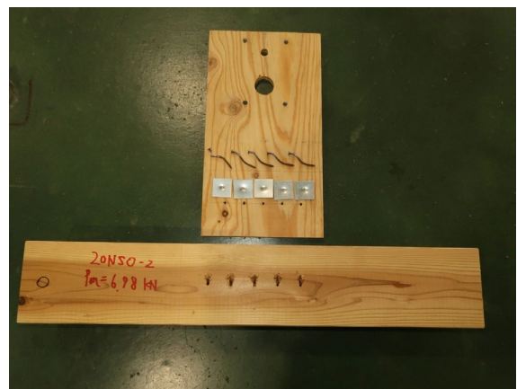
写真 3.5.2-19 2 体目破壊性状
