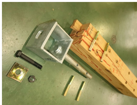
写真 3.5.4-10 10RDSP-4 木材の割れ
