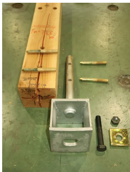
写真 3.5.4-30 20RDSP-4 木材の割れ
