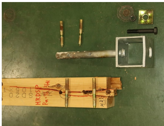
写真 3.5.4-39 HDRDSP-1 木材の割れ
