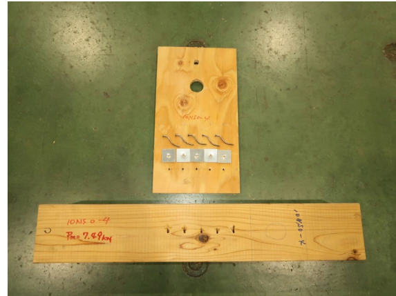
写真 3.5.2-9 4 体目破壊性状
