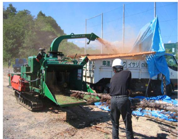
写真 2.3.19 自走式ブラシチップパーによるチップ化
