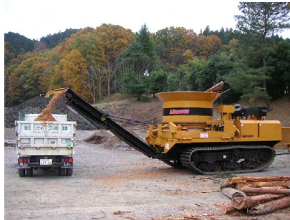
写真 2.3.27 自走式タブグラインダーによるチップ化
