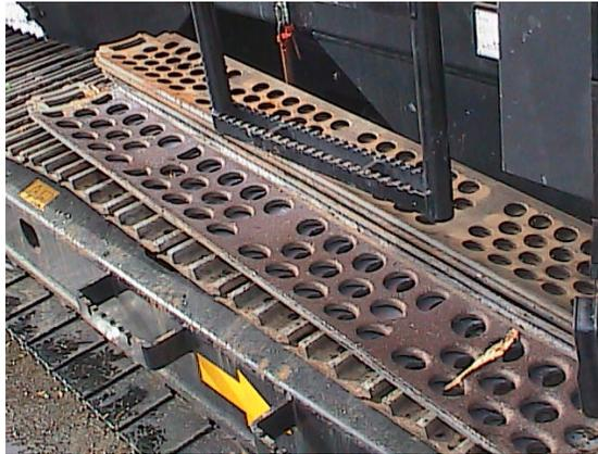
写真 2.1.5 破砕機網目
