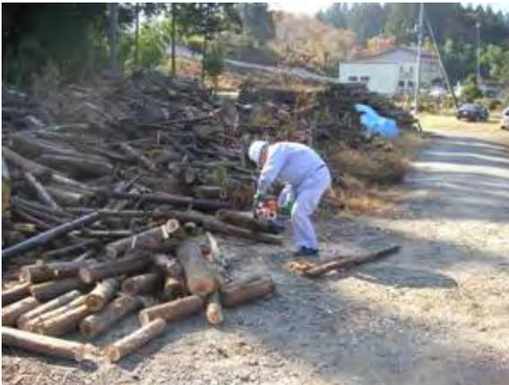
写真 2.3.24 チェーンソーによる玉切り
