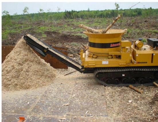
写真 2.1.3 タブ式破砕機
