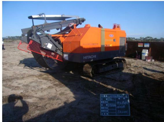
写真 2.1.9 移動式破砕機
