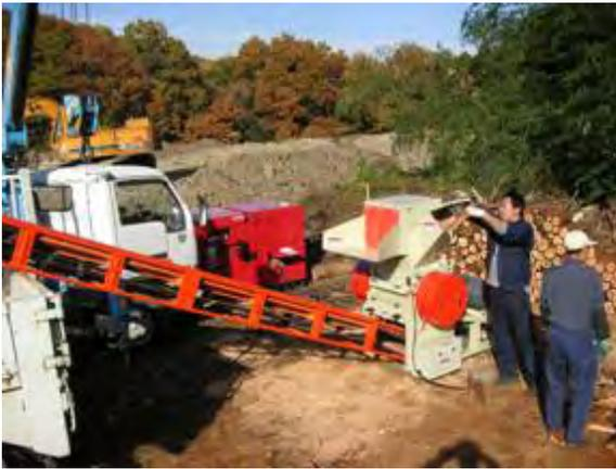
写真 2.3.22 固定式切削チップパーによるチップ化
