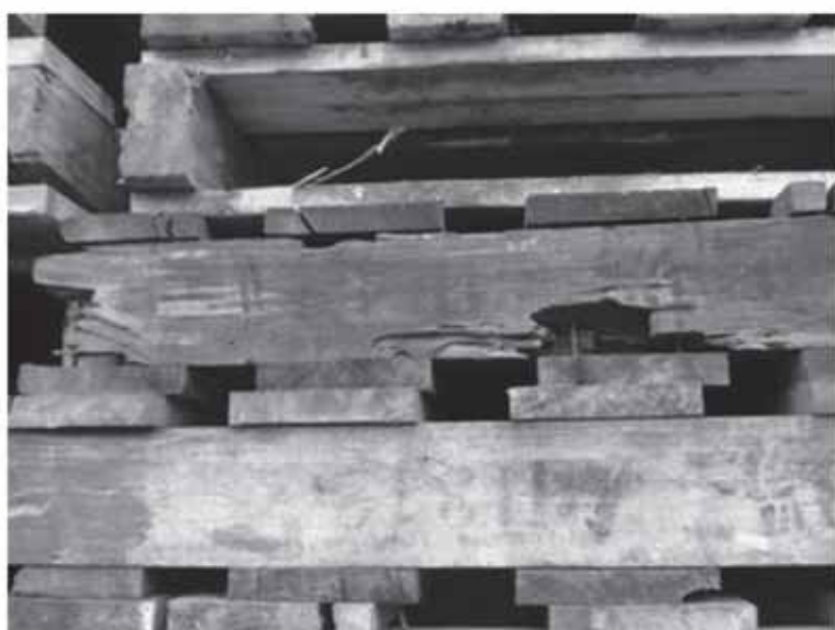
【パレットの破損】
