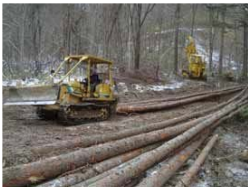
写真 1.2.1 ブルドーザー集材
