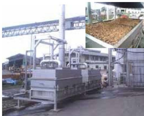
写真 1.12.1 チップ乾燥機の一例と乾燥チップ (右上)
