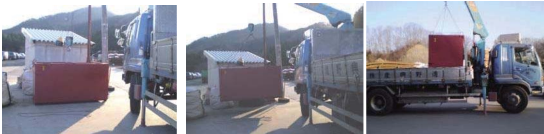
図 2. 4. 12 D 材回収の専用バケット 運搬イメージ
