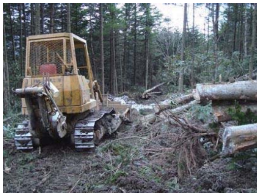
写真 2.2.3 ブルドーザー集材
