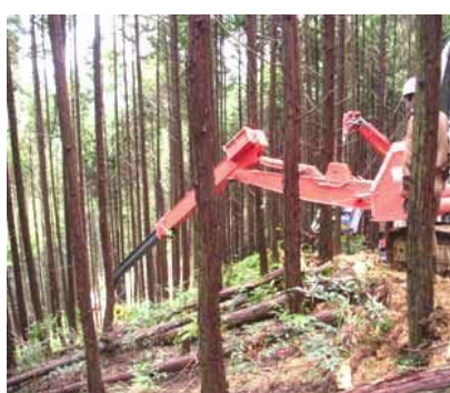
写真 1. 11. 1 ロングアームスイングヤーダを用いた集材試験
