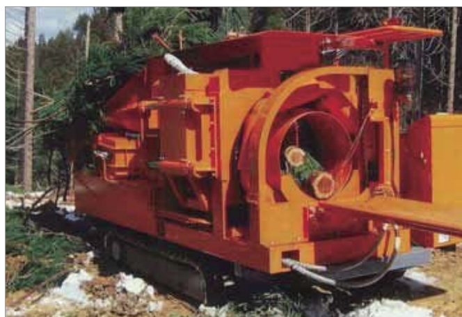
図2.7.10 圧縮結束装置の外観
