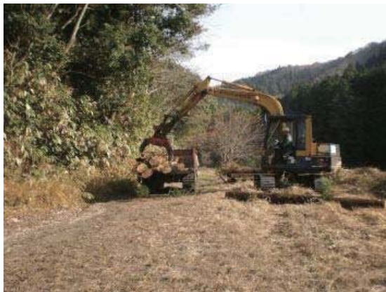
写真 2.5.7 土場整理・積込（グラップル）
