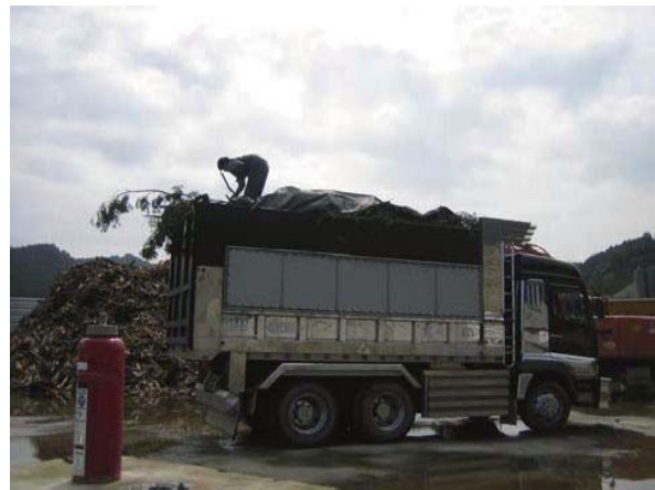
写真 2.6.2 11 t 深底ダンプ車 容積 26 m 3
