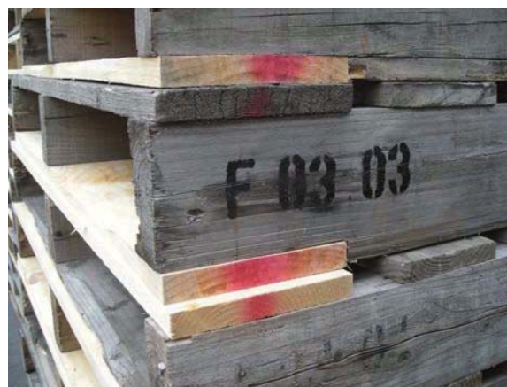
写真 2.8.1 リフォームされたパレット (赤くマーキングのある板がリフォーム部分)
