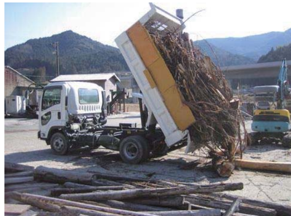
写真 2.6.4 4 t ダンプ車 容積約 10 m 3 (あおり付き)
