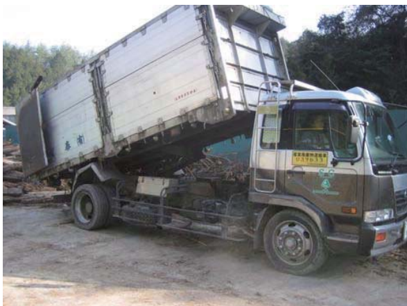
写真 2.6.3 8 t ダンプ車 容積 18 m 3
