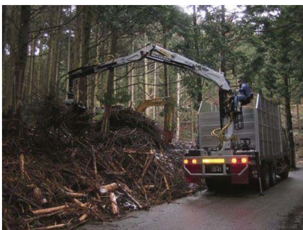
写真 2.6.5 11 t ツカミ付きトラック 容積 26 m 3
