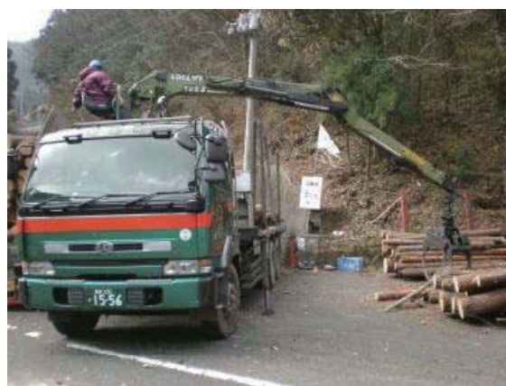
写真 2.5.30 積込・輸送（グラップル付 11 t トラック；パルプ・チップ原木）
