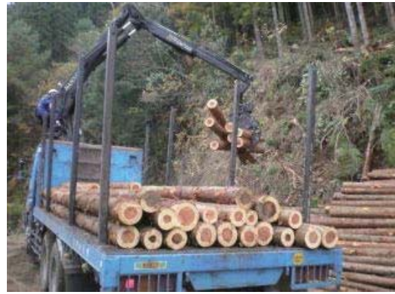
写真 2.5.23 積込・輸送 （グラップル付 10 t トラック）
