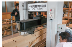
接着重ね梁の破壊試験。
