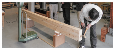
接着重ね梁の材料検査。
